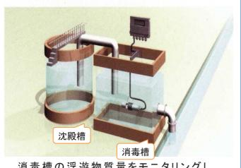
消毒槽の浮遊物質量をモニタリングし、異常時には、警報および放流停止
