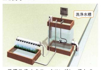
循環洗浄水をモニタリングし、汚れのレベルに応じて自動で給水・排水を制御
